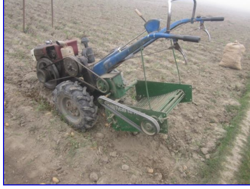
চিত্র ১: বারি আলু উত্তোলন যন্ত্র
